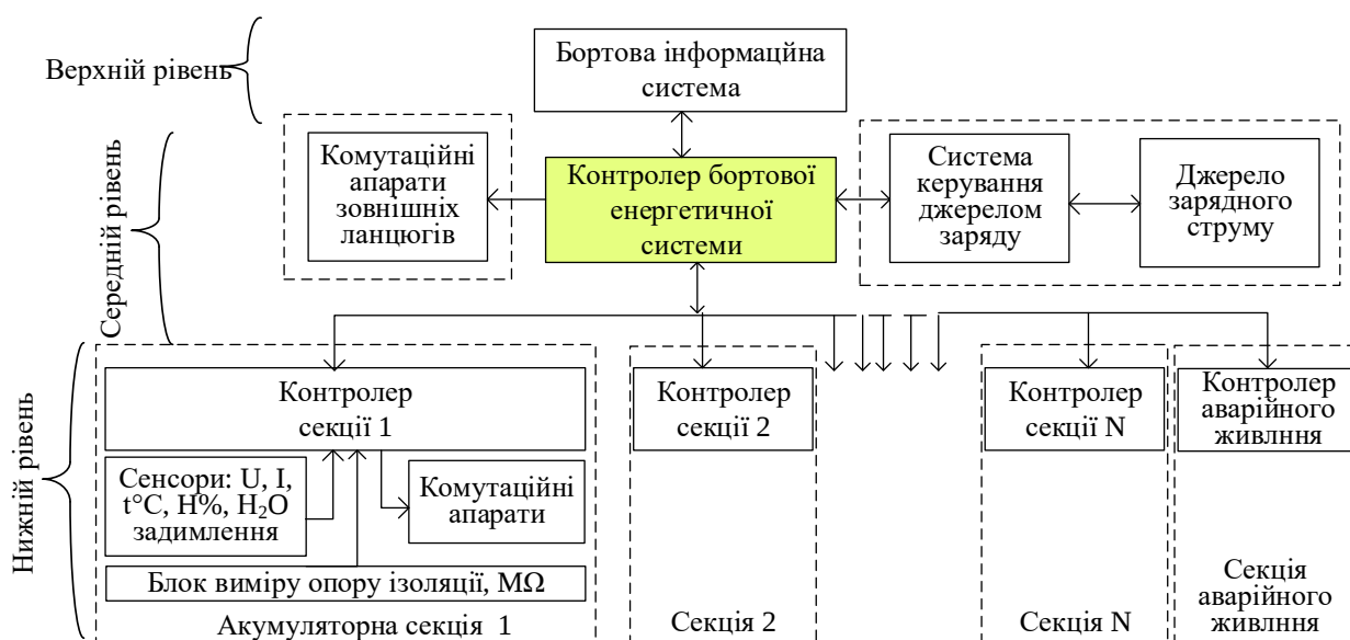
Рис. 4. Узагальнена структура системи автоматичного контролю технічного стану акумуляторної електроенергетичної системи БНС
