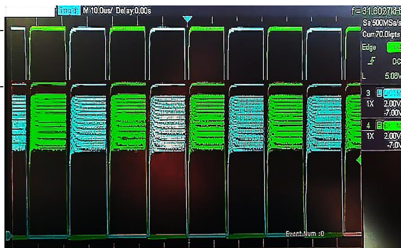
Рис. 3. Осцилограми імпульсів керування транзисторами Hot-side моста.
