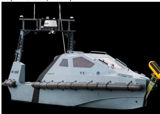
V. в – БНС «Inspector 90»
