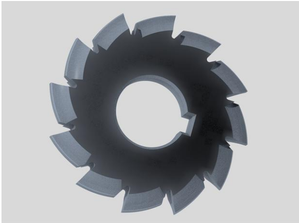
Рис. 4. Тривимірний модель дискової зуборізної фрези
