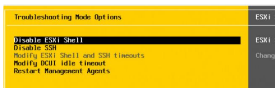
Рис. 10. Включення SSH на хосту ESX
