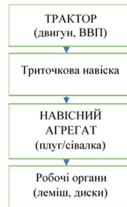
Рис. 1. Схема машинно-тракторного агрегату з навісним обладнанням
