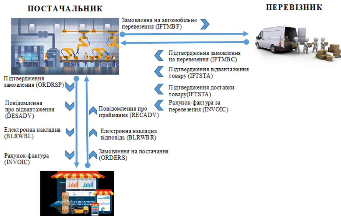
Рис. 3. Варіант схеми реалізації функціонування системи EDI
