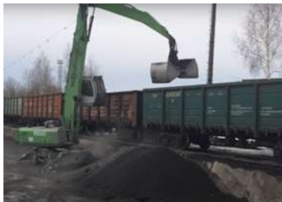
Рис. 1. Розвантаження вагона грейферним ковшем
