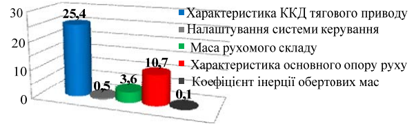
Рис. 9. Рівень впливу факторів на значення питомих витрат електроенергії для середньої швидкості на перегоні 42 км/год
