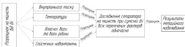
Рис. 2. Алгоритм розрахунку посудини, що працює під тиском
