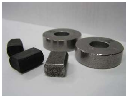
Рис. 3. Зразки для вимірювання зносостійкості деталей
