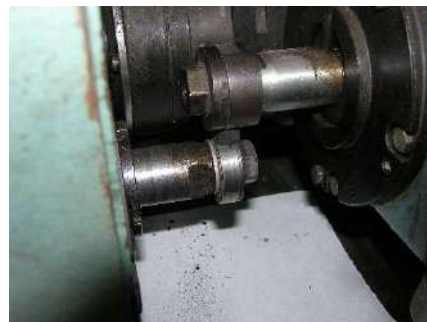
Рис. 4. Закріплення деталей на машині тертя
